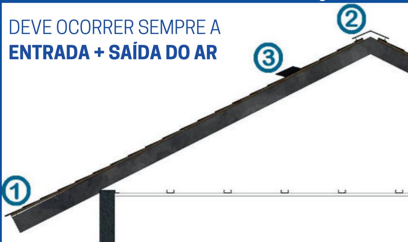
**1: PERFIL BEIRAL VENTILADO:** Entrada de ar necessária para ventilação funcionar, pelos beirais do telhado.
